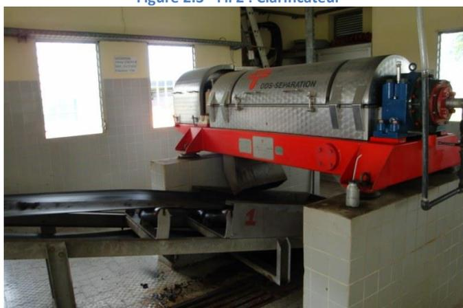
Figure 2.4 - Centrifugeuse
